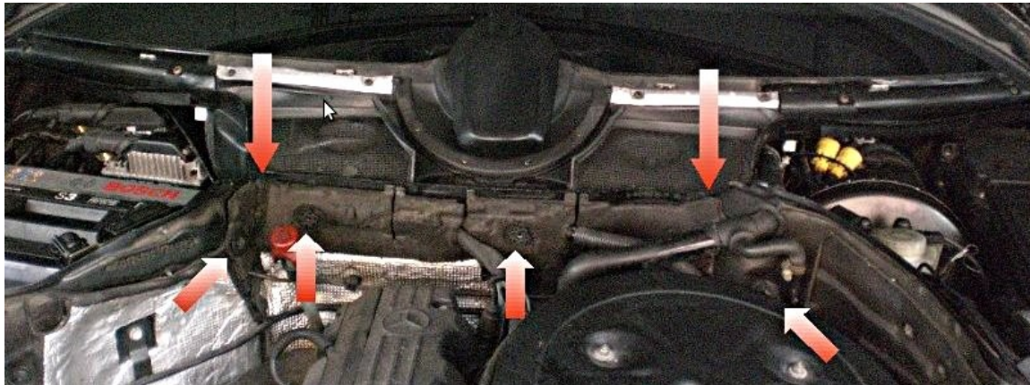
Abbildung 5: Die 4 großen Kunststoffschrauben, mit der die Dämmmatte gehalten wird, entfernen. Weiter unten befinden sich noch zwei Kreuzschlitzschrauben mit denen das Mittelstück befestigt ist.
