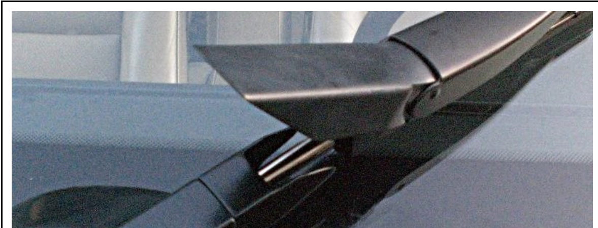
Abbildung 1: Abdeckung des Scheibenwischerarmes vorsichtig anheben und schräg nach oben abziehen.
