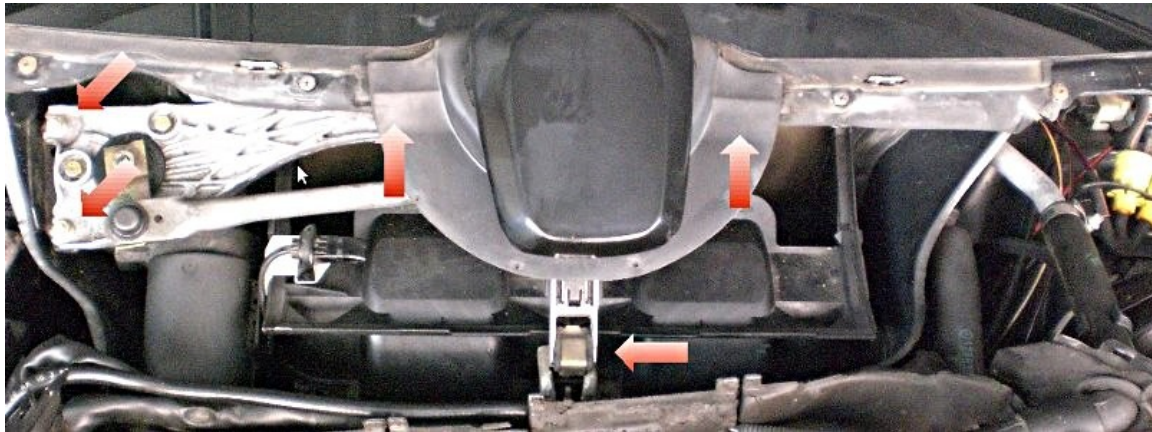
Abbildung 7: Der Scheibenwischer inkl. Motor ist nun zugänglich. Zum Ausbau die beiden Schrauben links und die beiden Schrauben unter der Gummischürze entfernen. Der Scheibenwischer wird vorne noch abgestützt und zusätzlich durch einen Gummipuffer gedämpft. Zur Demontage den Metall-Clip mit einem Schraubendreher vorsichtig heraus hebeln. Zum Schluß nicht vergessen, den Stecker abzuziehen.
