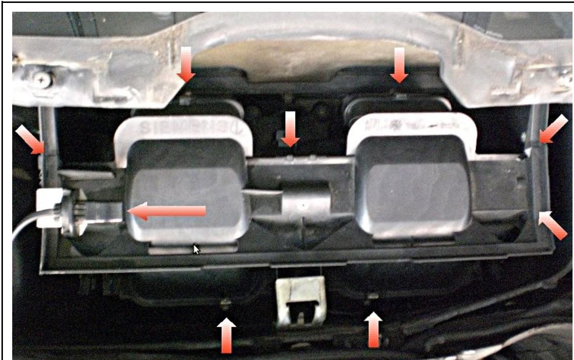
Abbildung 9: Die Abdeckung des Gebläselüfters ist mit insgesamt acht Klammern befestigt. Sie lassen sich mit einen Schlitzschrauben leicht lösen. Abschließend den Stecker (links im Bild) abziehen.
