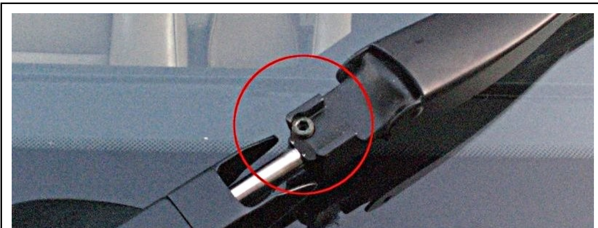
Abbildung 2: Imbuss-Schraube lösen und Scheibenwischerarm abziehen. Das geht etwas schwer. Einfacher ist es, wenn man den Scheibenwischerarm in Ruhestellung bringt und einen Schraubendreher als Hebelwerkzeug benutzt.
