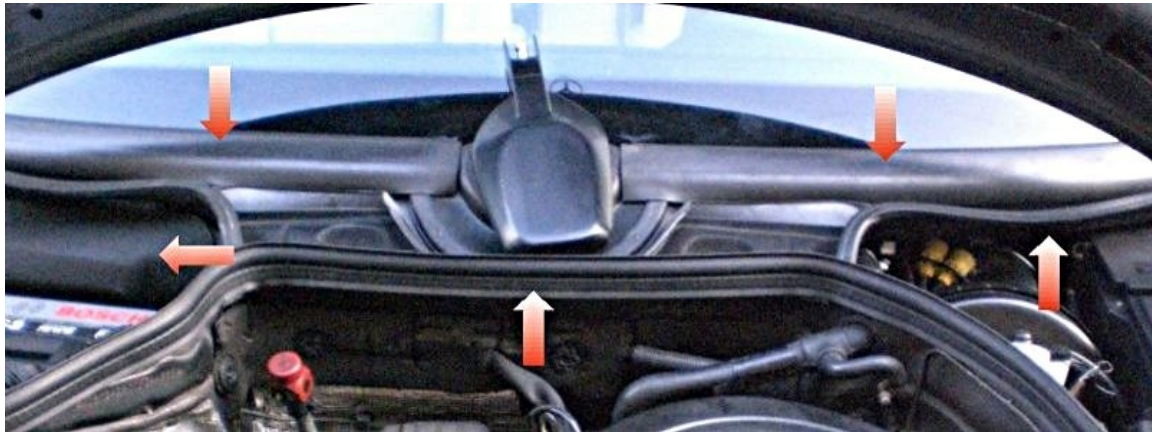
Abbildung 3: Zunächst die beiden Gummileisten (am unteren Ende der Windschutzscheibe) rechts und links des Scheibenwischers vorsichtig entfernen. Dazu am besten einen Schraubenzieher in der Nähe des Scheibenwischers unter die Gummileiste stecken und die Gummileiste mit leichtem Druck aus den Klemmen hebeln. Danach beide Gummidichtungen abnehmen. Abschließend die Abdeckung hinter der Batterie herausnehmen.
